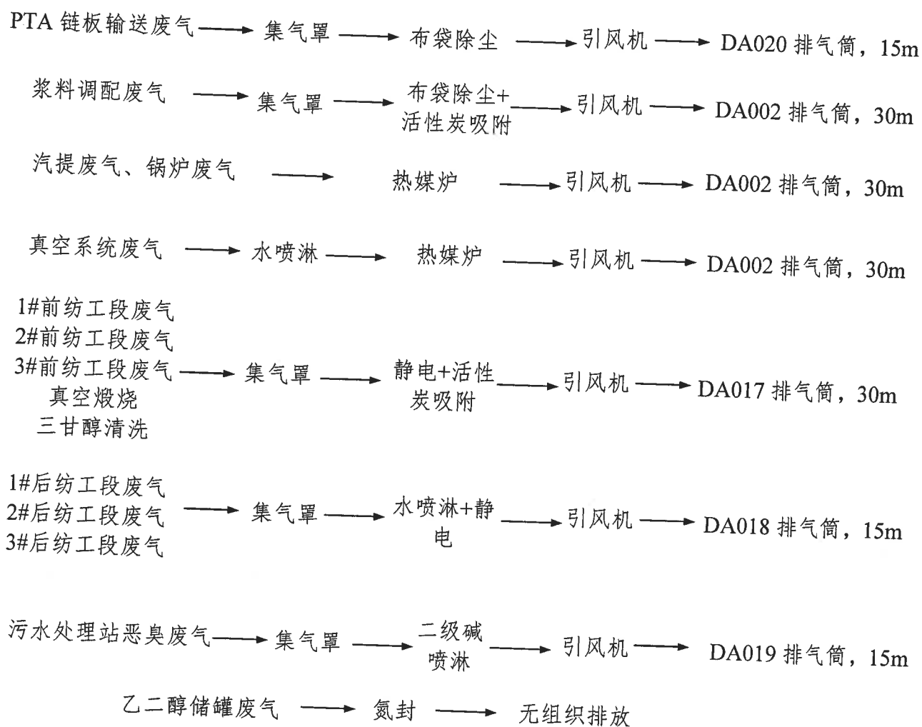
图 4-3 废气收集处理工艺流程
